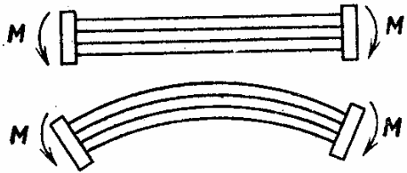
Рис. 8.39. Изгиб стержня моментами, при которых касательные напряжения не возникают
